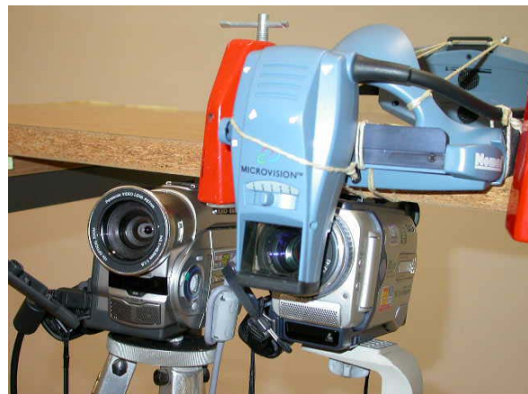
Abbildung 4: HMD, Trackingkamera und „Kamera-auge“ wurden fest installiert
